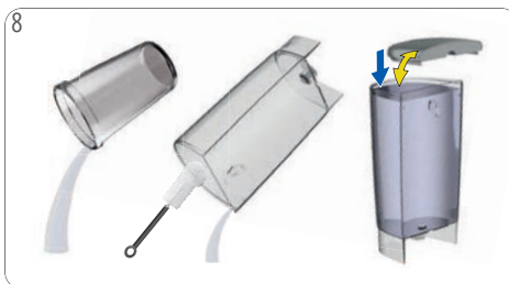
8 Videz et nettoyez le récipient. Rincez et nettoyez le réservoir d'eau. Utilisez une brosse propre utilisable pour les produits alimentaires et un détergent au besoin. Remplissez le réservoir d'eau potable fraîche et insérez-le dans la machine. Placez le récipient sous la sortie de boisson.
