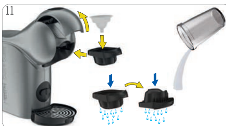
11 Enlevez le récipient. Videz et nettoyez le récipient. Sortez le porte-capsule. Enlevez l'accessoire de rinçage. Placez-le en lieu sûr pour un nettoyage ou un détartrage ultérieurs. Rincez les deux côtés du porte-capsule avec de l'eau potable fraîche. Réinsérez le porte-capsule.
